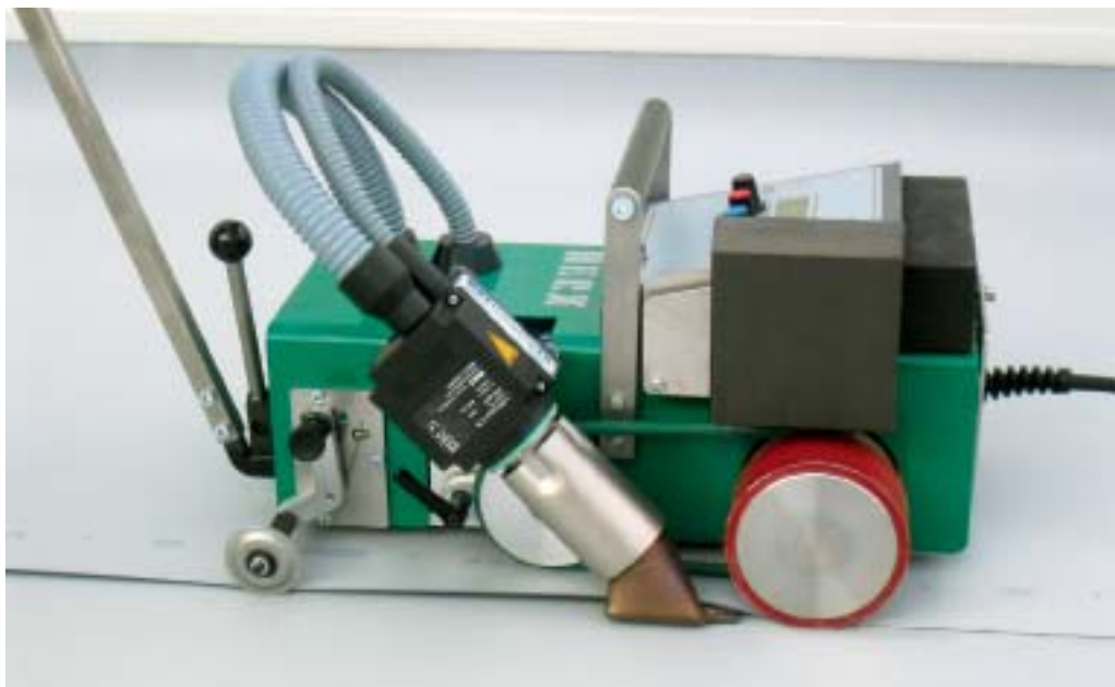
A kisebb forrólevegős automatákkal is lehet 40 mm széles varratot készíteni
